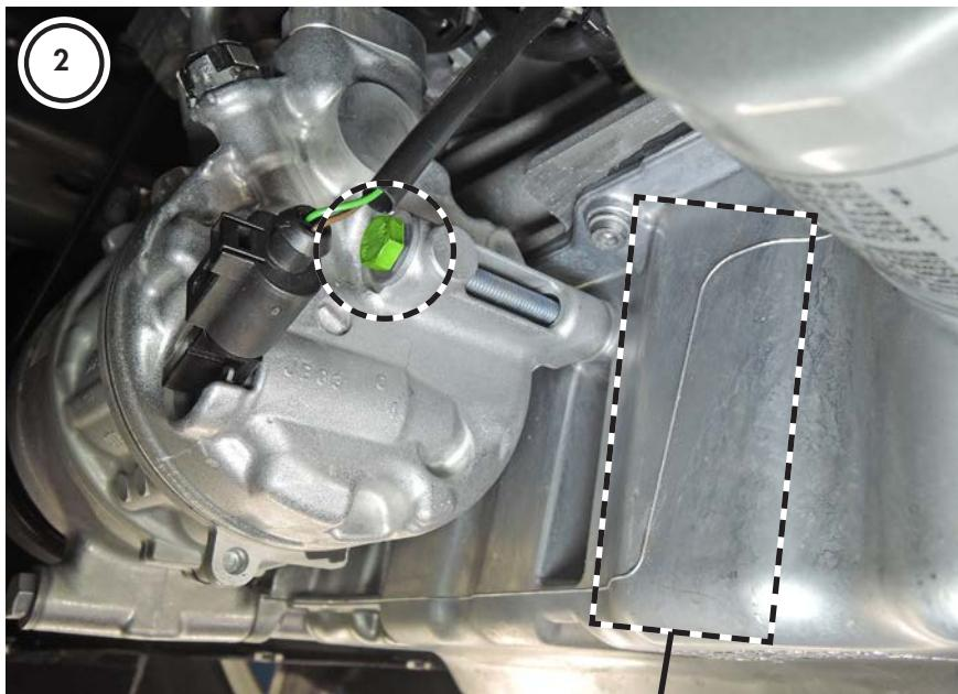
**OBS!** Fila/slipa bort gjutskägget på ytan där värmaren ska monteras.
